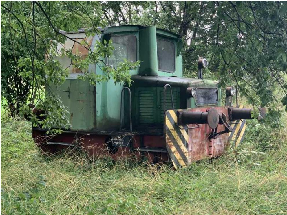
Die Kleinlok mit Baujahr 1964 wurde in der Maschinenfabrik CHRISTOPH SCHÖTTLER GmbH, in DIEPHOLZ Bez. BREMEN hergestellt, hat einen Hatz-Zweizylinder-Dieselmotor mit 22 PS und ist voll betriebsfähig. Mit dem Zweiganggetriebe schafft sie im 1. Gang max. 7 Km/h und im 2. Gang max. 15 Km/h. Sie könnte auf dem Bahnhofareal für kleine Rangierfahrten mit ca. 2 Wagen eingesetzt werden. Die Länge über Puffer beträgt 4.50 m und das Gewicht 7.5 to.
