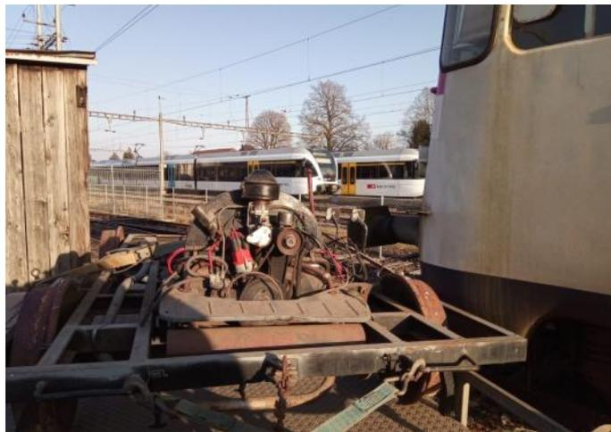
*Der Kleinwagen Klv 12 Fabr.No.2764, wurde in der Beilhack G.m.b.H in (D) Rosenheim 1957 hergestellt. Dienstgewicht 1500 Kg, Nutzlast 750 Kg. Er wird auch als Bahn-Nebenfahrzeug oder auch Bahnmeisterei-Draisine bezeichnet. Er diente für Streckenbereinigungen und Instandhaltungsarbeiten an Bahnanlagen.*
