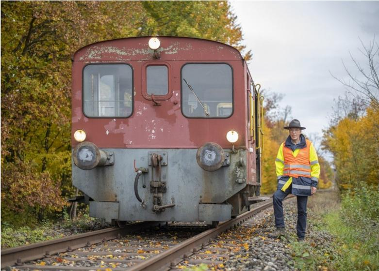
Der Schienentraktor Tm 784 musste wegen eines Kühlerdefekts abgestellt werden. Eine Reparatur lohnt sich nicht mehr. Inzwischen dient er als Ersatzteilspeicher und hat seine Kupplung dem Tm 801 gespendet.
